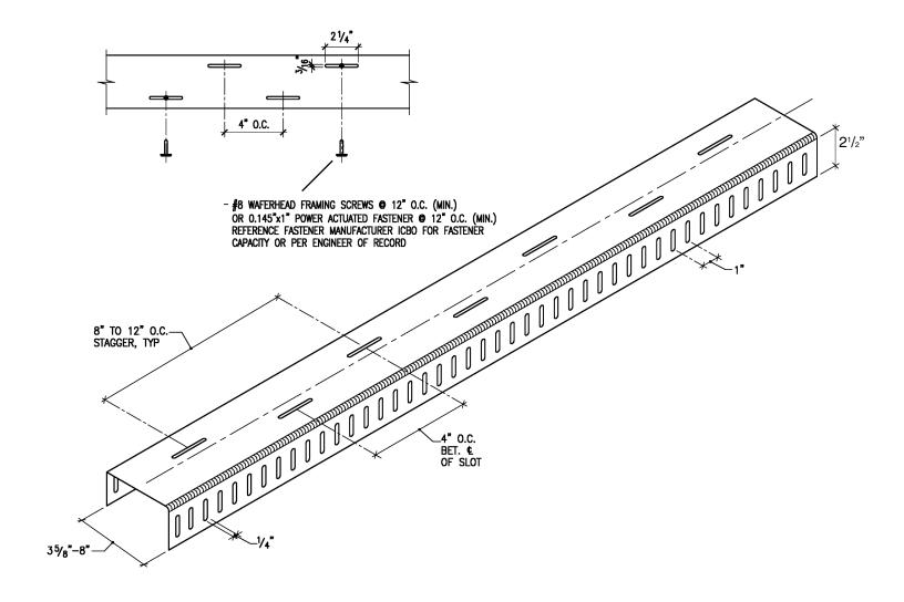
OPTIONAL — PER ENGINEER OF RECORD HORIZONTAL SLOTTED SLIDING CONNECTION — CBC 2001 Vol. 2
